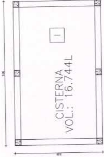
02 PLANTA BAIXA CISTERNA A SER AMPLIADA
