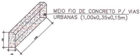
03 DETALHE DO MEIO FIO esc: 1:50
