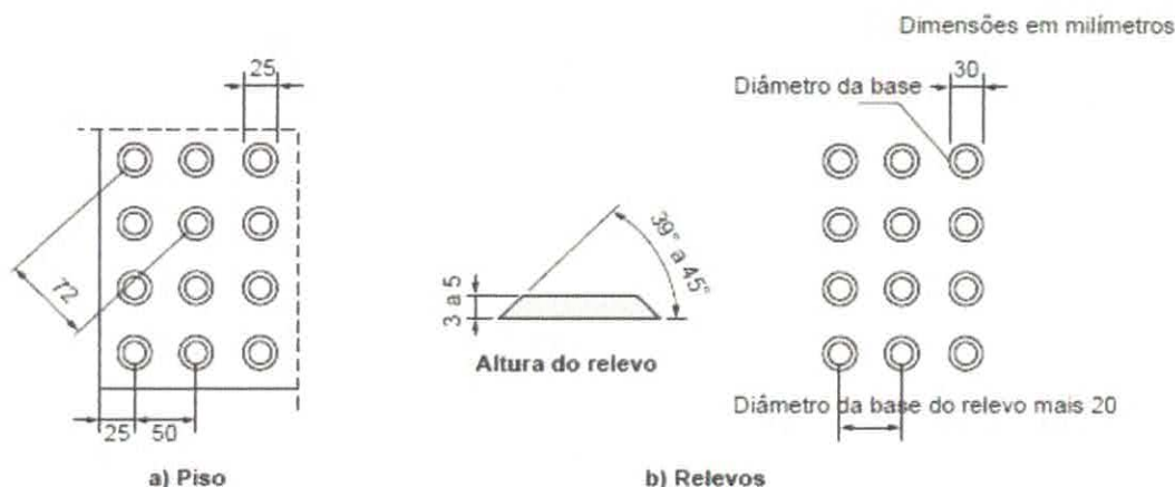
Figura 62 – Sinalização tátil de alerta e relevos táteis de alerta instalados no piso
